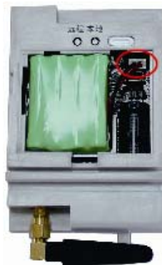
图 8 后备电池安装
