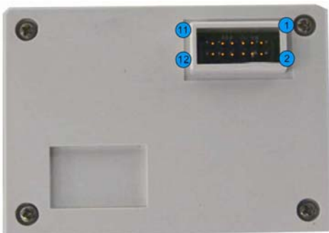
图3 模块接口底视示意图
