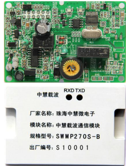
图 1 单相载波通信模块和外壳
