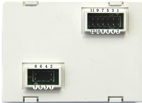
图 3 模块接口底视示意图
